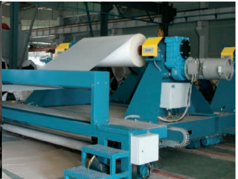
Doppel-Zentrumsabwickler mit motorischem Antrieb
