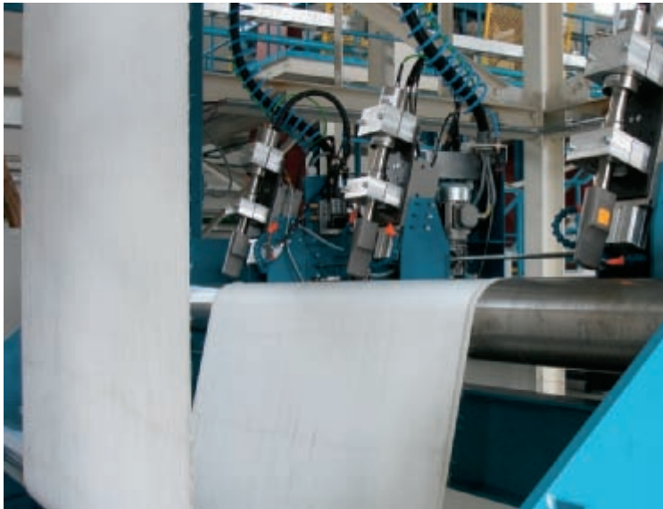
Schneidanlage mit 3 Köpfen und automatischer Verstellung
