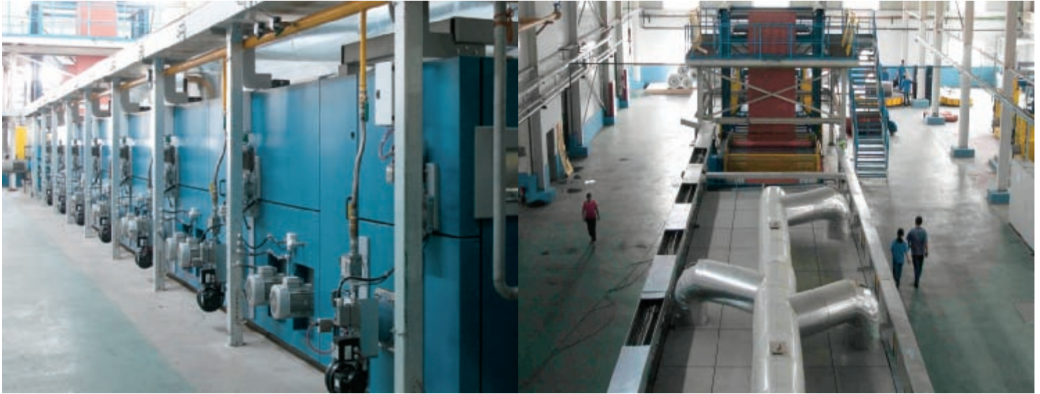
Spannrahmen mit zentralem Abluftsystem
