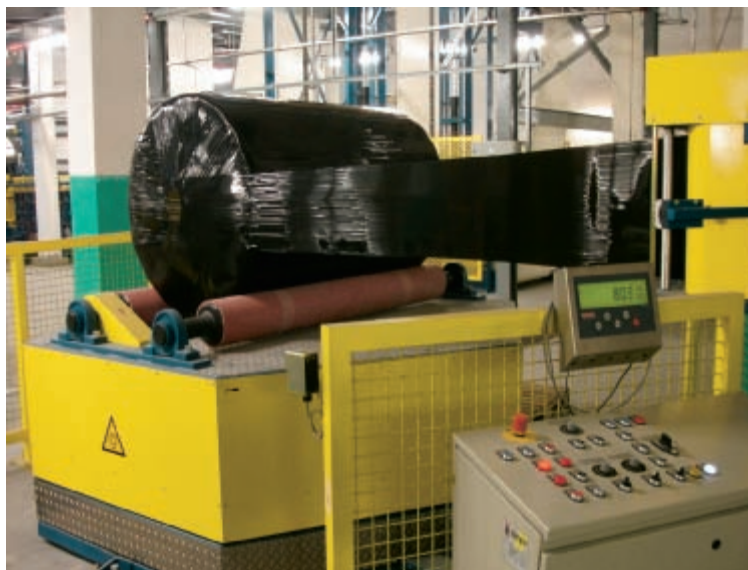
Wiege- und Verpackungsanlage
