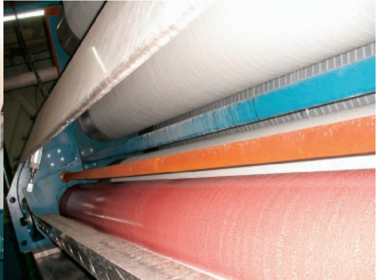
Integriertes Reinigungssystem für Quetschwalze
