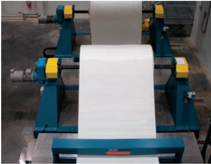
Doppel-Zentrumsabwickler mit automatischer Warenzentrierung
